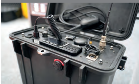
BAGStation, stazione radio base da campo per Centrale operativa
