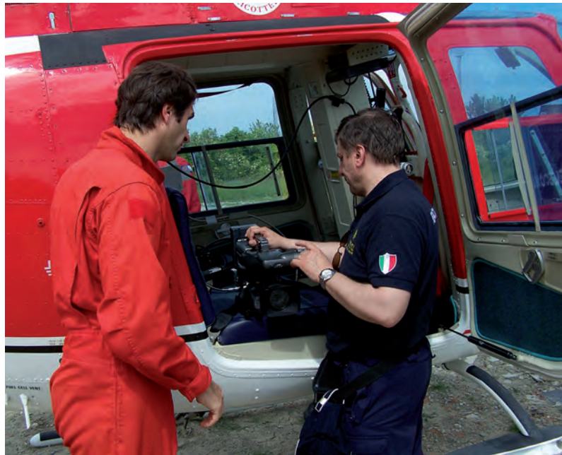
Si sperimenta un nuovo impianto di TLC su un elicottero dei Vigili del Fuoco
