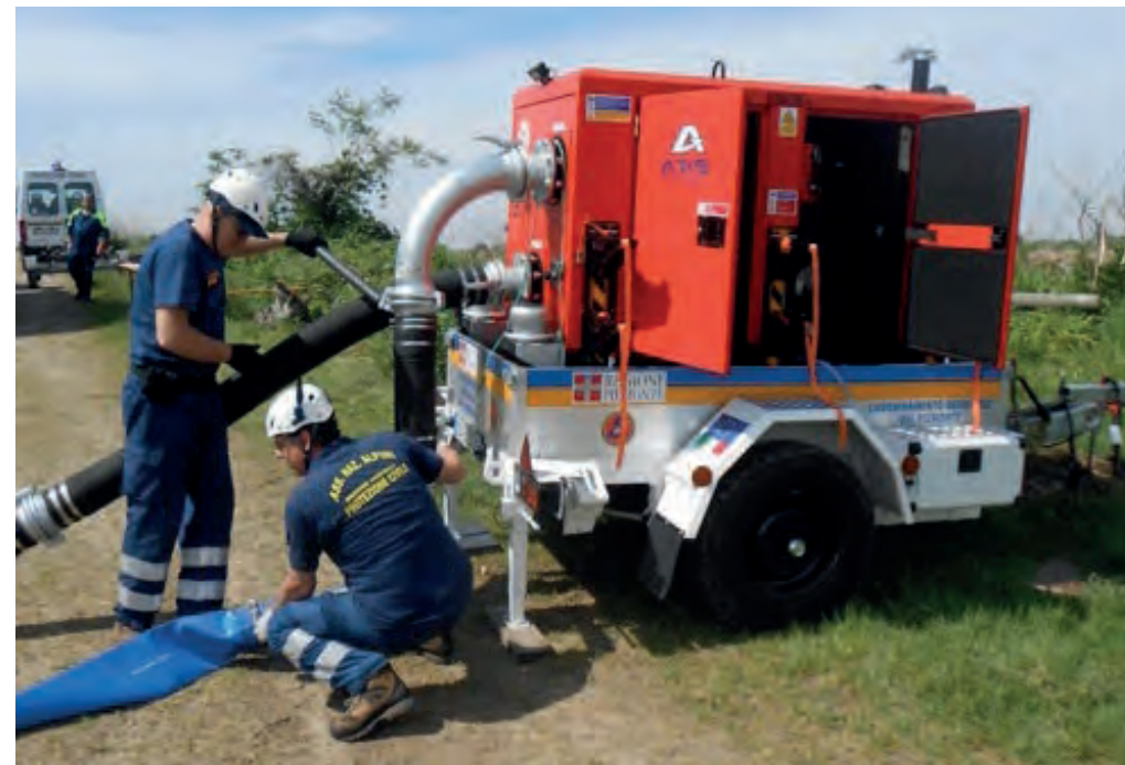
Prove di funzionamento pompa HCP da parte degli operatori del modulo
